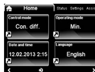
Рис. 1 Пример дисплея на насосе TPE Серия 2000 с расширенной панелью управления
