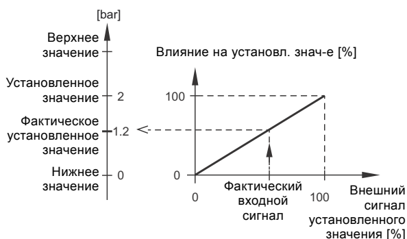
Рис. 24 Пример настройки регулирования установленного значения
