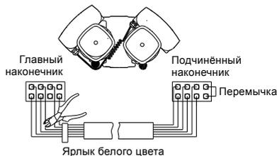
Рис. 14 Удаление «переменного режима работы» и «резервного режима»
