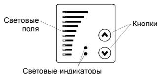
Рис. 17 Панель управления насосом с однофазным электродвигателем
