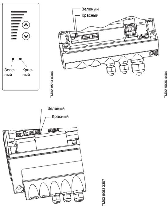
**Рис. 29** Световые индикаторы на насосах с трёхфазными электродвигателями
