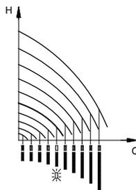
Рис. 20 Настройка производительности насоса в нерегулируемом режиме
