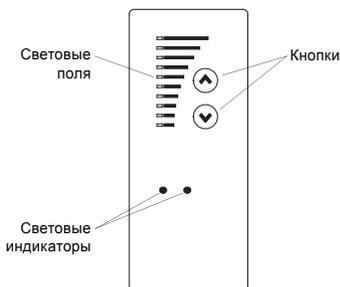
Рис. 18 Панель управления насосами с трёхфазными электродвигателями
