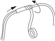
**Рис. 34** Изоляция проводов
