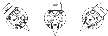
Рис. 7 Расположение клеммной коробки у одинарных насосов
