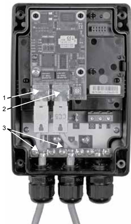
Рис. 5 Пример подключения по Ethernet
