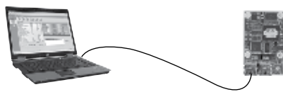
Рис. 7 CIM 500 соединён с ПК с помощью кабеля Ethernet
