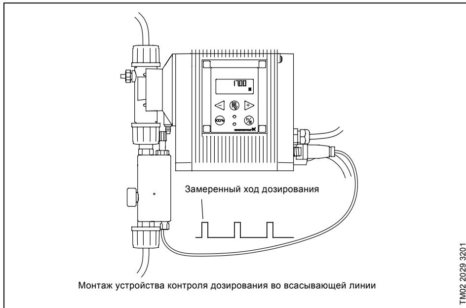
Оно предназначено для контроля процесса дозирования жидкостей, которые могут вызвать скапливание воздуха в дозирующей головке. В результате процесс дозирования прерывается, хотя насос-дозатор продолжает работать.
