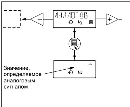
Если был выбран аналоговый сигнал 4-20 мА или 20-4 мА, а значение сигнала 2 мА, то индицируется сигнал неисправности насоса-дозатора. Такое может случиться, если возник обрыв соединения, например в результате повреждение провода.
