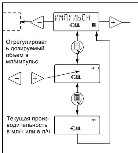
В том случае, когда установленное значение объема дозирования, приходящееся на 1 импульс, умножается на частоту внешнего импульса, превышающую производительность насоса, последний работает в режиме дозирования с максимальной производительностью. Лишнее число импульсов просто игнорируется и на дисплее индицируется "текущая производительность".
