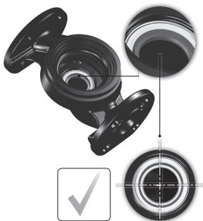
Рис. 15 Правильно выровненная система уплотнений
