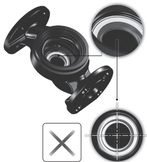
Рис. 16 Неправильно выровненная система уплотнений
