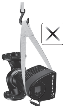
Рис. 9 Неправильный способ стропки насоса
