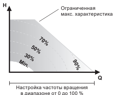
Рис. 52 Ограничения по мощности и давлению, влияющие на максимальную характеристику
