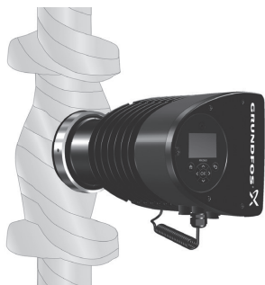
Рис. 18 Изоляция корпуса насоса и трубопровода
