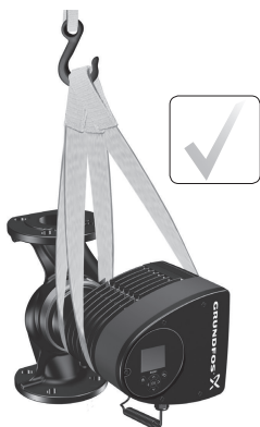
Նկար 8 Պոմպի ճիշտ կապման եղանակ
