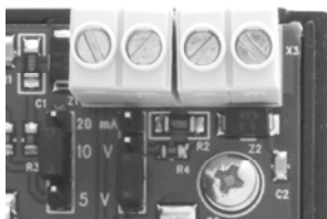
Рис. 6 ST1 (выход 1) установлен на 2-10 В, а ST2 (выход 2) - на 1-5 В
