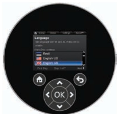
Рис. 57 Панель управления, мастер первого пуска
