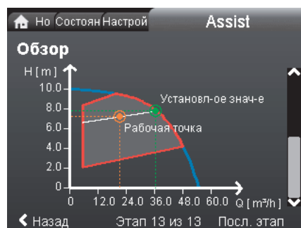
Рис. 9 Пример расчета установленного значения на основании выбранного режима управления и введенных значений Q и H
