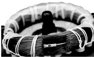
Рис. 26 Датчик РТС, встроенный в обмотку
