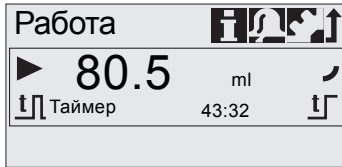
Рис. 29 Ежедневное дозирование по таймеру (перерыв в дозировании)
